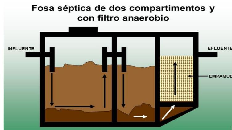
*Figura 2.3: Tanque Séptico-Filtro Anaerobio*
