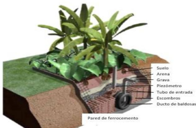
**Figura 2.7:** Vista transversal del sistema TEvap
