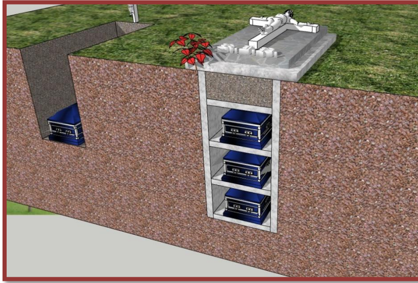
Imagen 13: Sistema de enterramiento de estructura.
