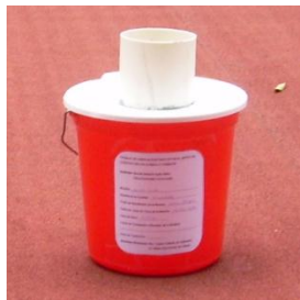
Figura N°29. Frasco recolector de muestras de agua lluvia para polvo sedimentable y lluvia ácida.
