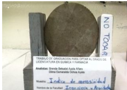
Figura N°30. Moneda de acero normalizada utilizada para muestreo de índice de corrosividad.
