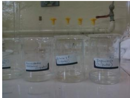
Figura N°34. Muestras de agua lluvia para la determinación de sulfatos.
