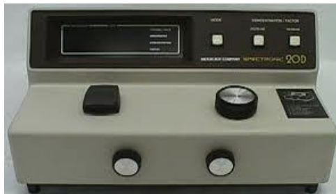
Figura N° 33. Equipo Spectronic 20 utilizado para realizar lecturas de absorbancia para determinación de sulfatos en agua lluvia.
