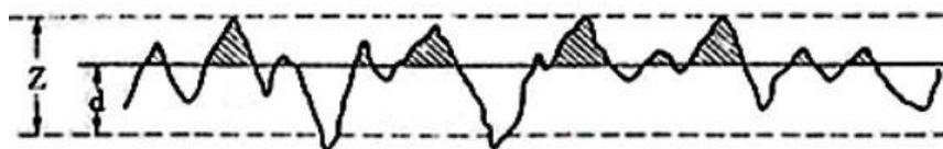
Fig. 1.8. Una superficie real penetrada por una superficie plana [4].
