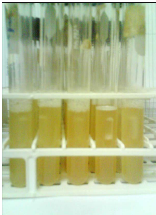
Fig. N° 4. Determinación de coliformes fecales en caldo EC.
