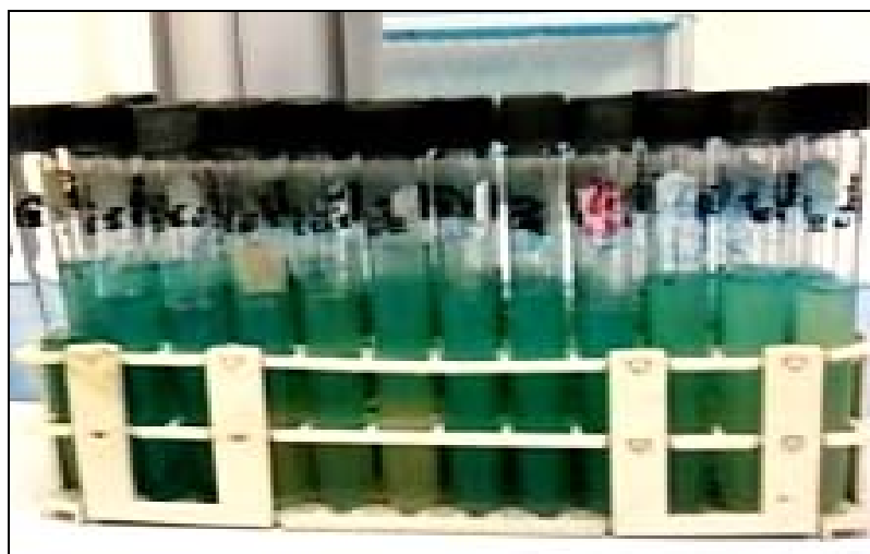
Fig. Nº 1. Determinación de coliformes totales en Rapid HiColiform broth.
