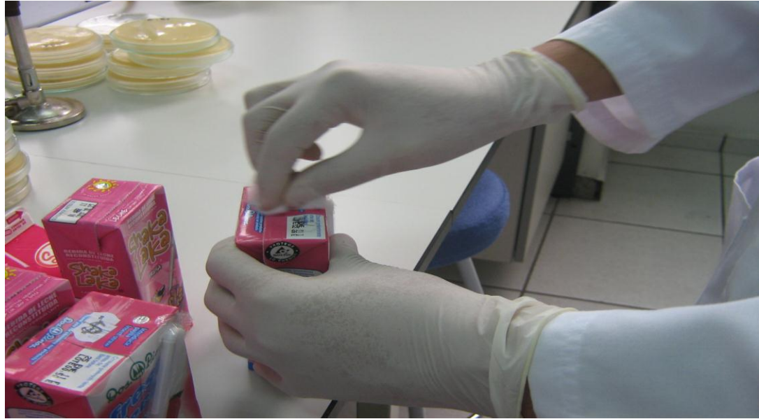
Figura N° 13. Pre-tratamiento de la muestra en forma aséptica, usando un algodón impregnado de alcohol etílico y frotando el empaque original de la misma con movimientos circulares.
