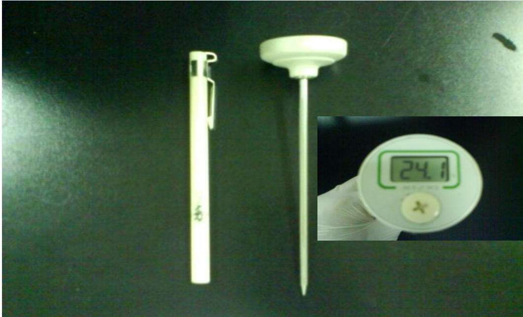
Figura N° 11. Termómetro digital utilizado para la toma de temperatura de almacenamiento registradas durante el muestreo de leches saborizadas.
