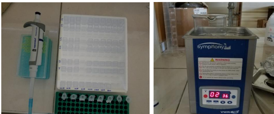
Figura N° 33. Disolución de muestras y preparación de celdas para Espectrofotómetro Ultravioleta Visible.
