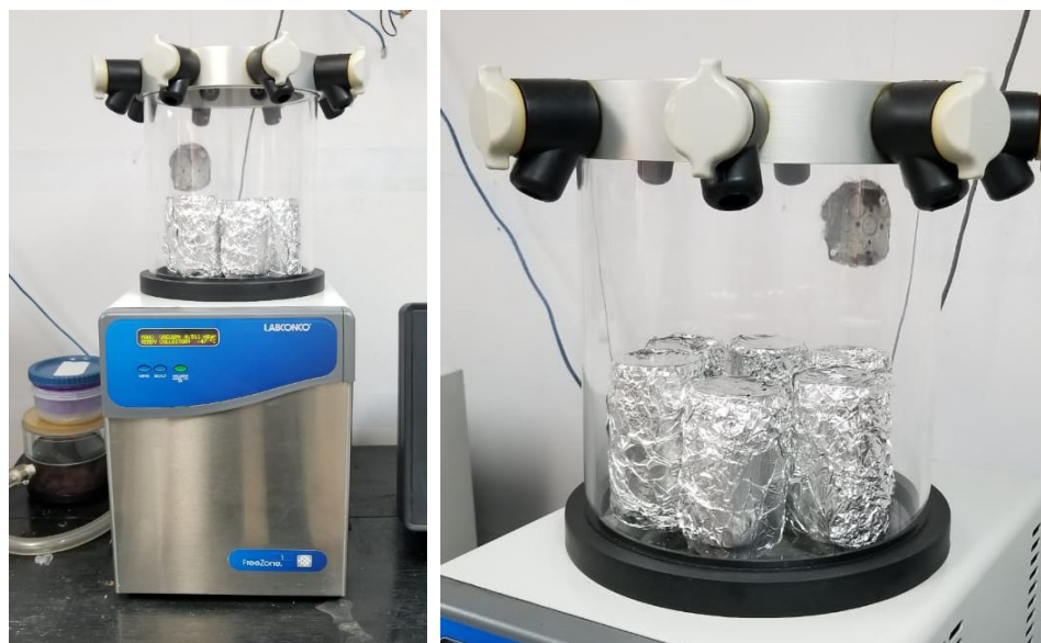
Figura N° 30. Proceso de liofilización de extractos acuosos.
