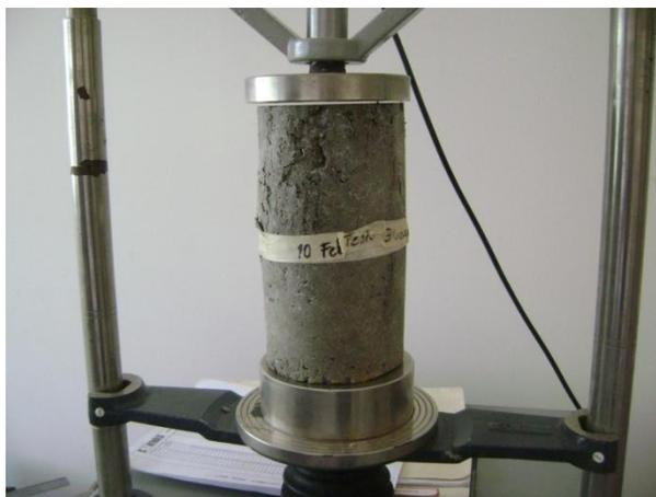
**Figura A-6.** Ensayo a compresión en cilindros de grout.
