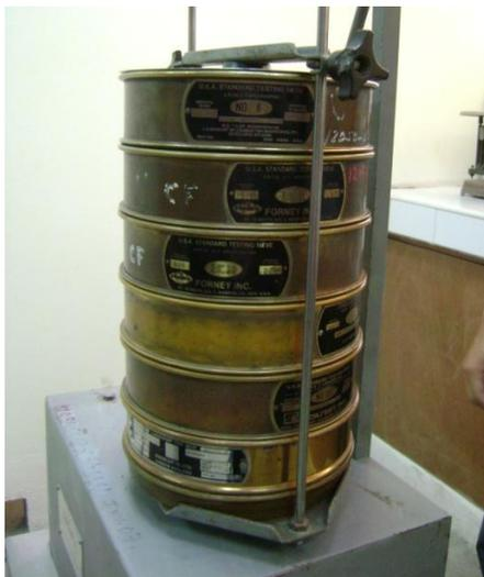
**Figura A-15.** Tamices para granulometría de grava.
