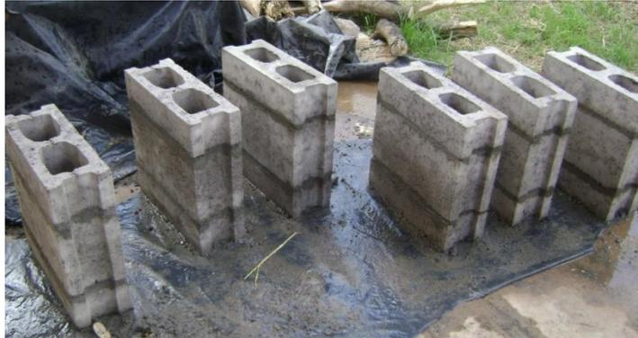
**Figura A-13.** Prismas para prueba de compresión de mampostería.
