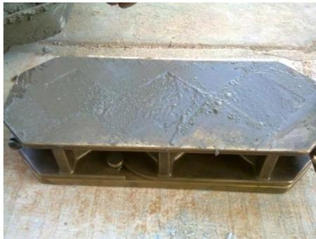
**Figura A-3.** Molde con muestras de mortero.
