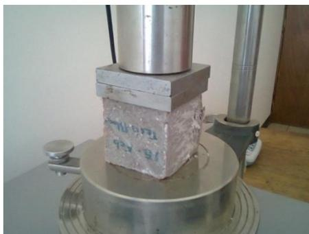
**Figura A-4.** Ensayo a compresión a cubos de mortero.
