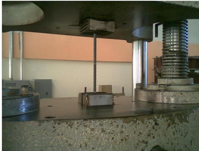
**Figura A-2.** Ensayo a tensión del acero en maquina Universal.
