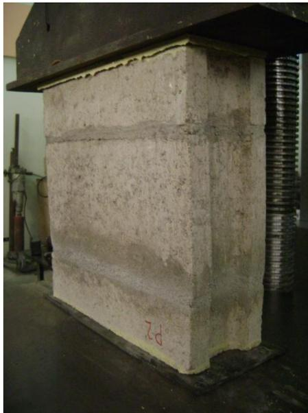
**Figura A-14.** Ensayo de compresión en prismas.
