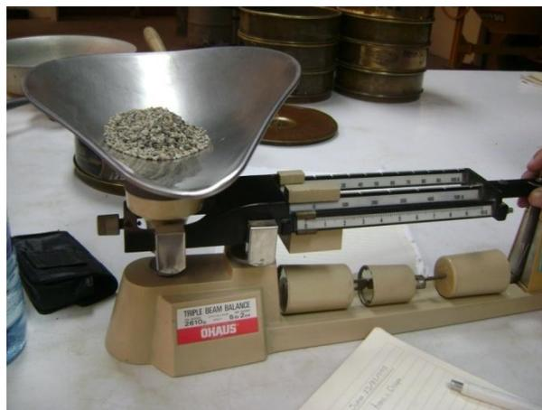
**Figura A-17.** Cuantificación de material retenido en cada tamiz.
