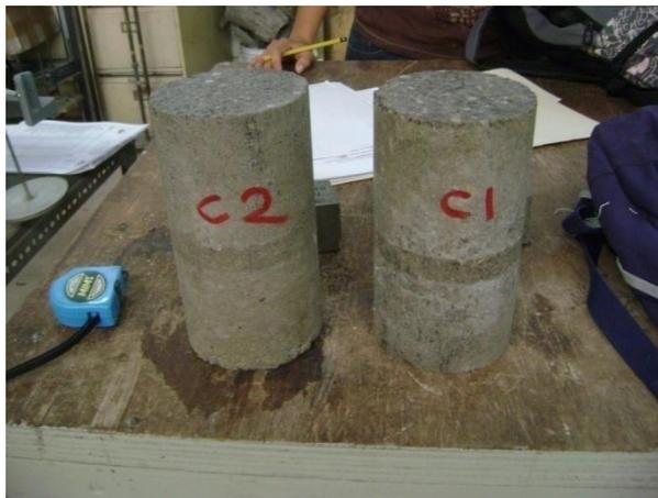
**Figura A-5.** Muestra de grout para ensayo a compresión.
