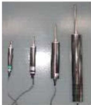
**Figura 3.23 Transductores de desplazamiento.**
