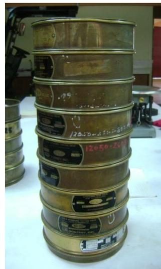
**Figura A-16.** Tamices para granulometría de arena.
