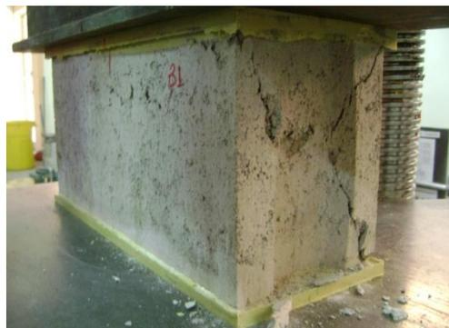
**Figura A-10.** Ensayo a compresión de bloque de concreto.
