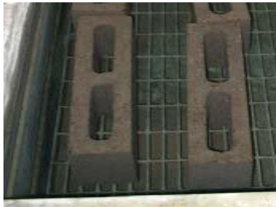
**Figura A-12.** Bloques sumergidos 24 horas.
