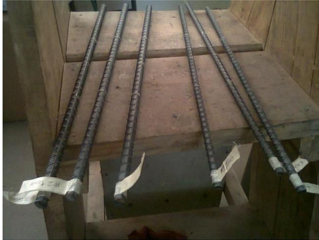
**Figura A-1.** Muestras para ensayo a tensión.
