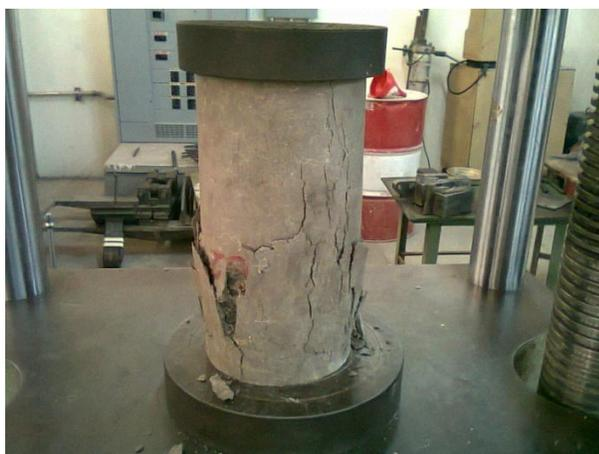
**Figura A-8.** Ensayo a compresión en cilindros de concreto.
