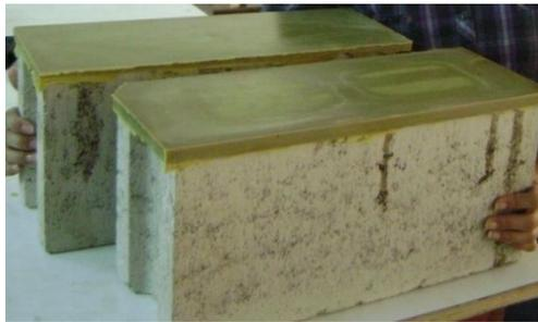
**Figura A-9.** Refrentado de bloque de concreto.
