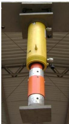
**Figura 3. 21 Gato hidráulico con celda de carga de 50 toneladas.**
