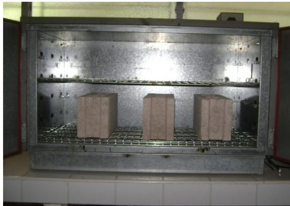
**Figura A-11.** Bloque secos 24 horas en horno.
