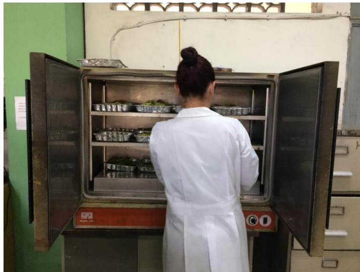
Figura A8. Uso de estufa para desecación de muestras.
