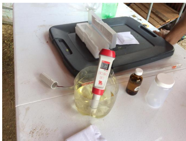
Figura A10. Medición de Ph en orina a la cual se añadió HCL para reducir su pH
