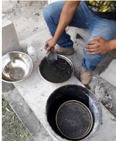
FIGURA 4.2: Lavado de agregado grueso pasado por el tamiz N°200
