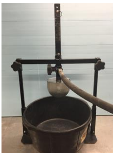
FIGURA 2.2: PRUEBA PARA LA PENETRACIÓN VIBRATORIA DE BOLA DE KELLY,
