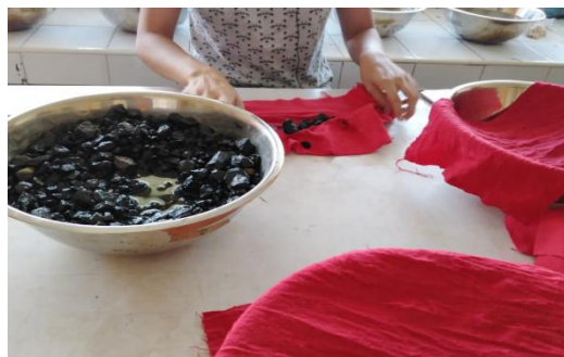
FIGURA 4.3: Secado con franela de agregado grueso
