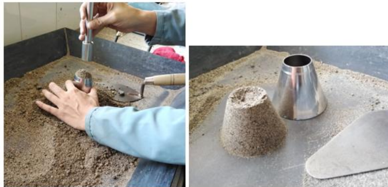
FIGURA 4.4: Procedimiento para obtener condición saturado superficialmente seco con agregado fino.
