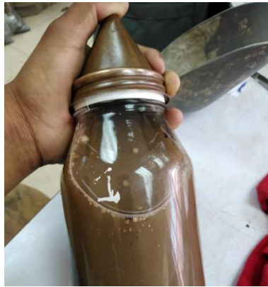
FIGURA 4.5: Procedimiento para eliminar el aire atrapado usando Picnómetro.
