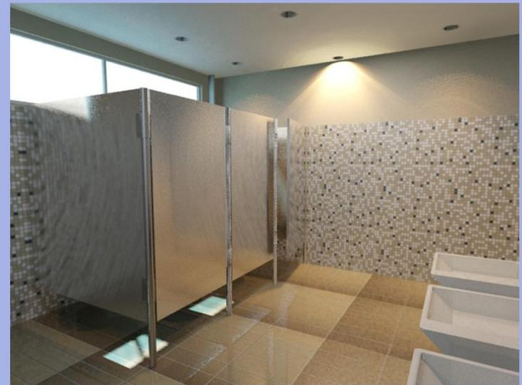
**SANITARIOS:** Vista interior de sanitarios tipo (arriba) y detalle de lavamanos (abajo), acabados en piso de porcelanato pulido antideslizante, paredes de bloque con enchape de cerámica, cielo falso de tabalyeso.
