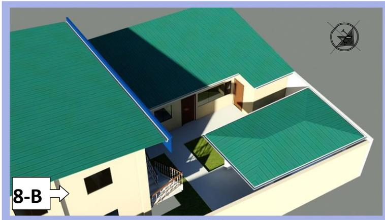
**VISTA AEREA PATIO POSTERIOR.** Glorieta para usos múltiples con piso tipo fachaleta, techo con cubierta de lamina sobre estructura metálica, y de cielo estructura vista.
