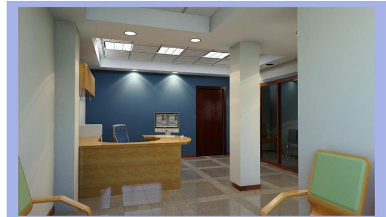
**VISTA INTERIOR DE RECEPCION.** Piso de ladrillo de porcelanato pulido, Paredes de doble forro de tabalcamiento sobre perfilaría metálica. Cielo falso y detalles de tablayeso, iluminación con lámparas fluorescentes.
