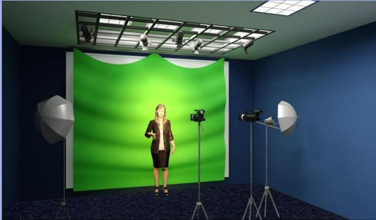
**SALON AUDIOVISUAL:** Vista interior de Cabina y Estudio de Grabación, acabados en paredes y cielos con materiales altamente acústicos. La iluminación con reflectores de varios tipos, según sea su uso. Vidrio fijo en ventana, puertas de madera, Y piso con acabado de alfombra colocado sobre losa.
