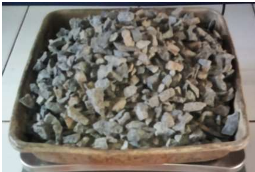
Figura 3.5 Grava número 3/8 utilizada para elaboración del concreto permeable
