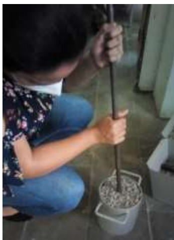
Figura 4.26 Procedimiento de Consolidación por Varillado
