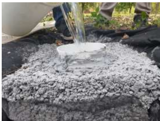
Figura 3.21 Proceso de Pre - humectación
