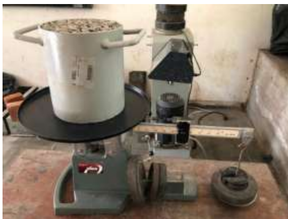
Figura 4.23 Pesaje del recipiente medidor con el agregado
