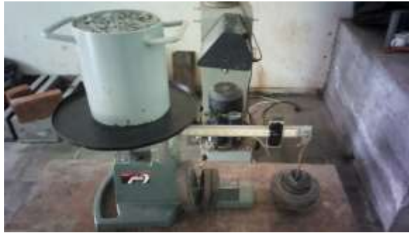
Figura 4.27 Pesaje del Recipiente Medidor con el Agregado
