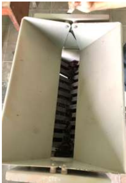
Figura 4.8 Vista de los conductos del partidor mecánico
