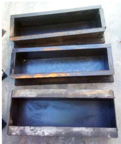
Figura 4.45 Moldes de vigas prismáticos de 60cm x15cm x 15cm
