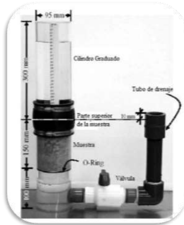
Figura 3.14 Permeámetro de carga variable
