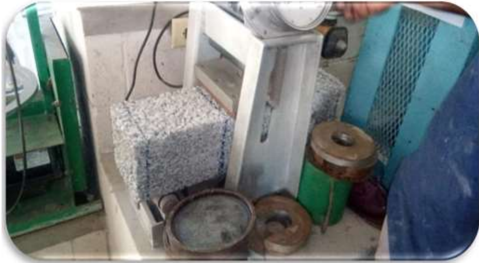
Figura 4.53 Ensayo a flexión de concreto permeable
