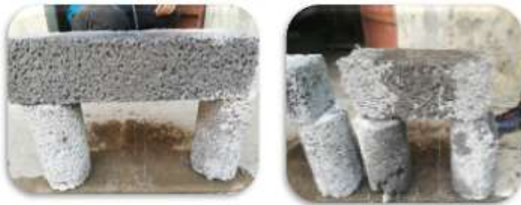
Figura 3.4 Cilindros de contenido de vacíos del 18% y 20%
