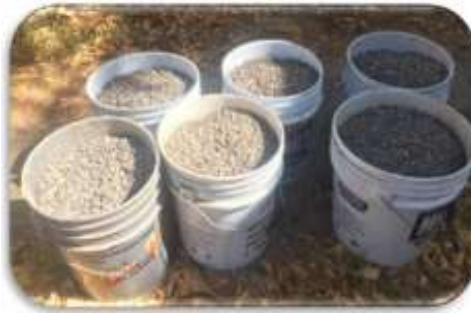
Figura 4.37 Grava #0 (chispa), de tamaño 3/8 según ASTM C-33
