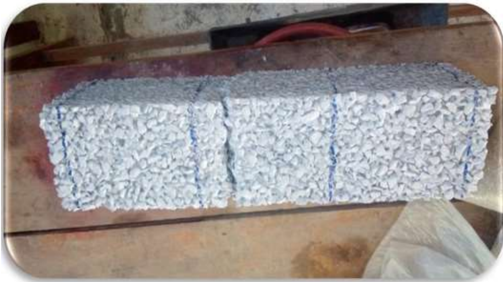
Figura 4.54 Ruptura del concreto permeable bajo norma ASTM C-78
