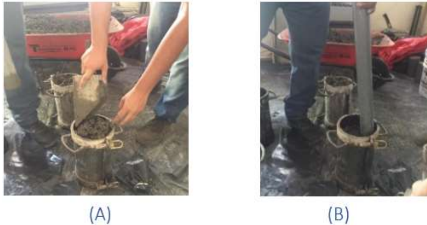
Figura 4.44 Colocación de concreto en moldes cilíndricos y distribución de golpes
