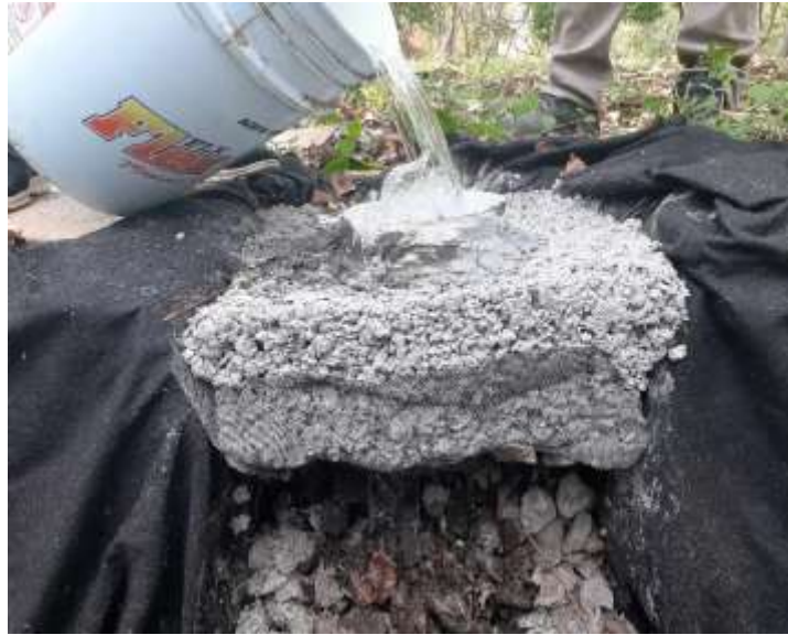
Figura 4.72 Vaciado de agua de 40 lb
