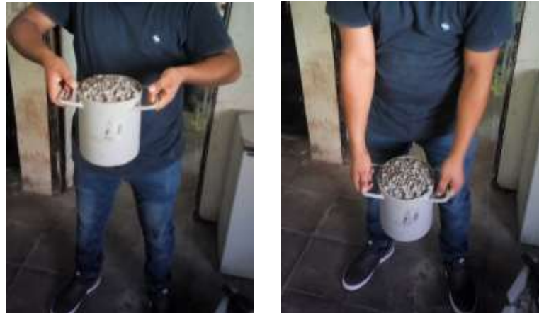
Figura 4.30 Procedimiento de Consolidación por Sacudido
