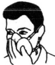
5. Comprobación de presión positiva. Tapar con la mano la válvula de exhalación y exhalar. Si el ajuste es bueno, la pieza facial se hinchará y no apreciarán fugas.
