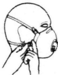
6. La tensión de las bandas puede reducirse empujando las hebillas por la parte posterior.
