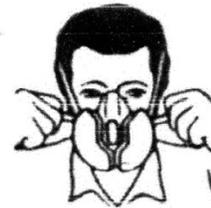
4. Ajustar la tensión de las bandas de sujeción tirando de sus extremos.
