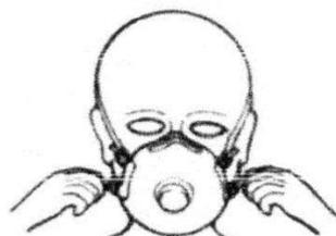
4. Ajustar la tensión de las bandas tirando de sus extremos.
