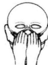
7. Para comprobar fácilmente el ajuste, tapar con las manos el respirador y la válvula e inhalar con fuerza. Debe sentirse que se crea vacío entre el respirador y la cara.
