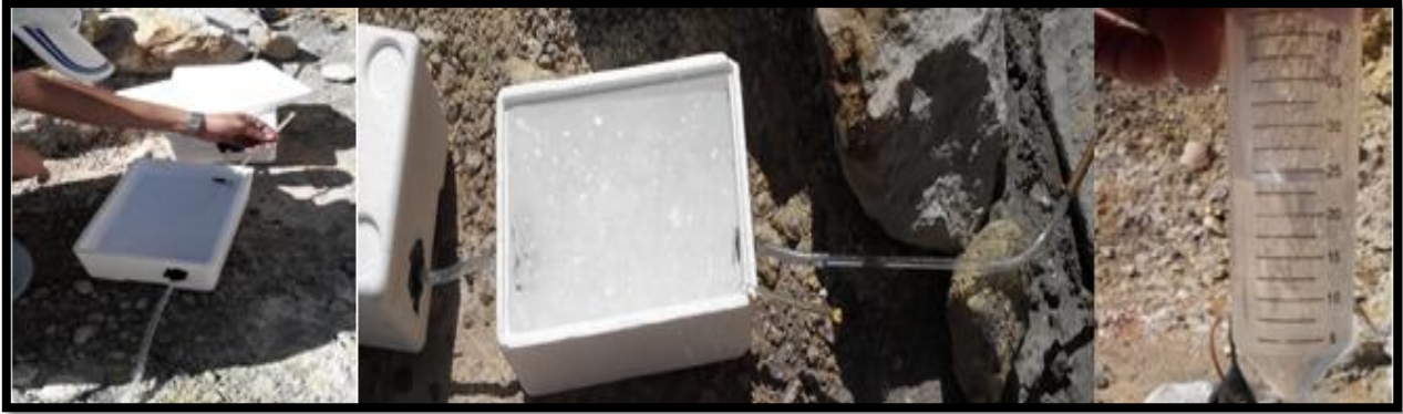
Figura 21. Toma de Parámetros en Condensados Fumarólicos y Medición del Caudal Recolectado
