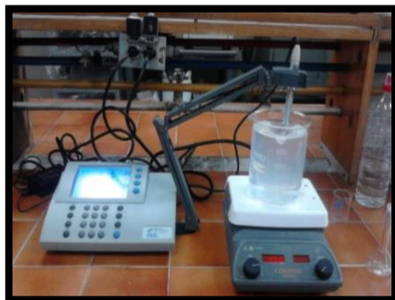
Figura 37. Proceso de adición de hidróxido de sodio para la coprecipitación del radio.
