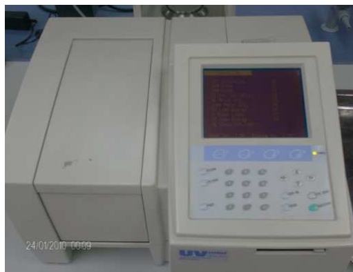
Figura N°4: Espectrofotómetro UV- Visible utilizado para la estandarización de las cepas.
