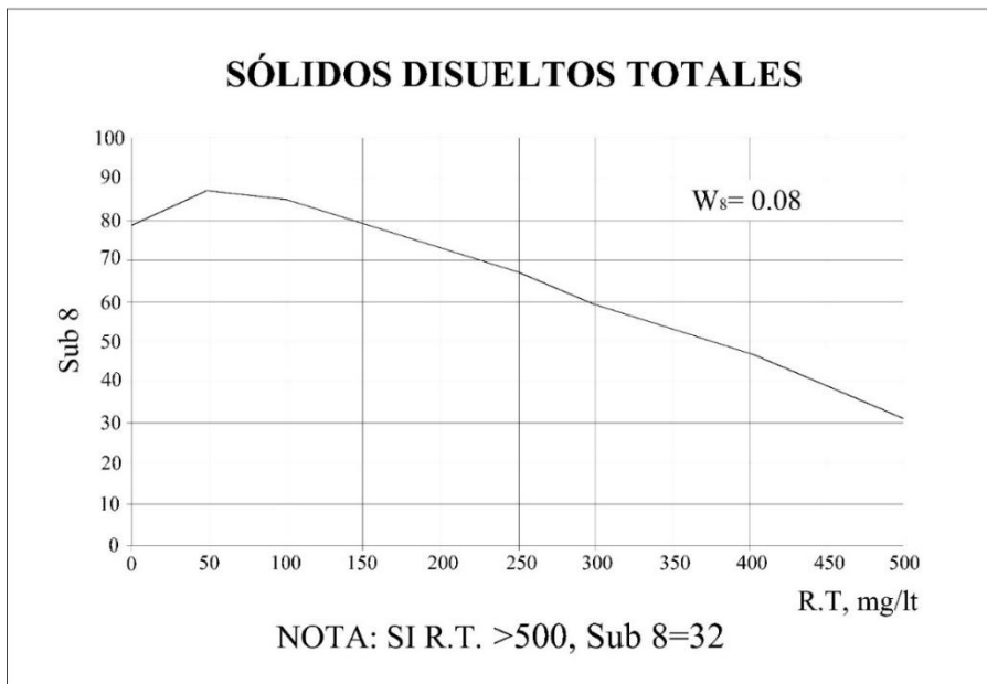
Ilustración 154. Obtención del Peso para Sólidos Disueltos Totales del Sitio de Muestreo No.1
