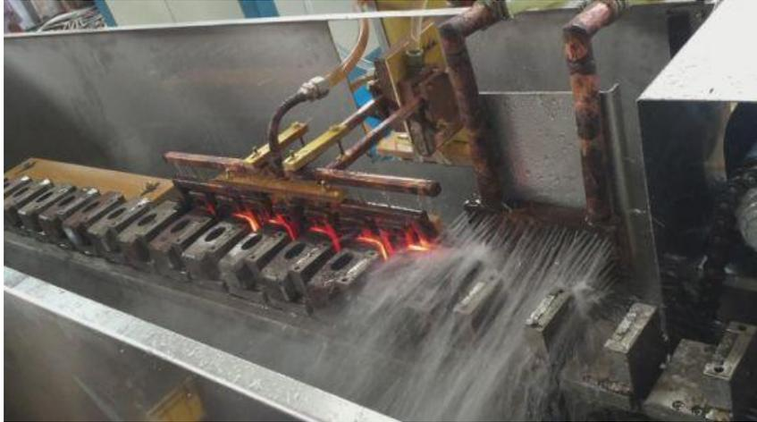
Fig. 1.17. Enfriamiento en línea utilizado en procesos de calentamiento por inducción [9].
