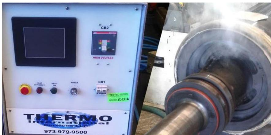
Fig. 1.18 Ejemplo de sistema de control utilizado en procesos de calentamiento por inducción [9].
