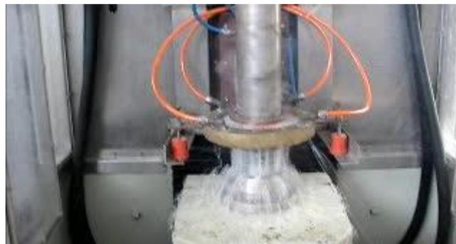
Fig. 1.9. Estación de normalizado por inducción [6].
