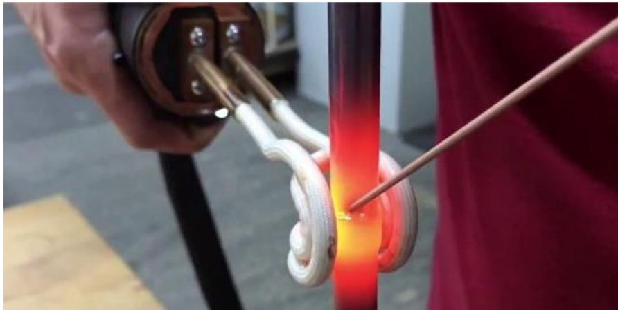
Fig. 1.7 Soldadura realizada con material de aporte con ayuda de calentamiento por inducción [6].
