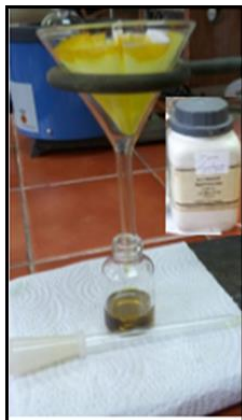
Figura 27. Eliminación de agua del aceite con sulfato de sodio anhidro ( \text{Na}_2\text{SO}_4 )
