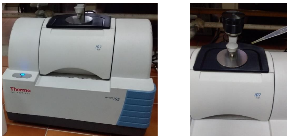
Figura 34. Equipo de Infrarrojo Thermo Scientific Nicolet y Unidad de Reflectancia Total Atenuada (ATR de ZnSe).
