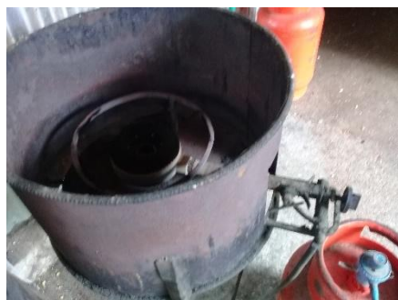
Fig. 22: Cocina de metal con quemador de gas, para freír o garrapiñar
