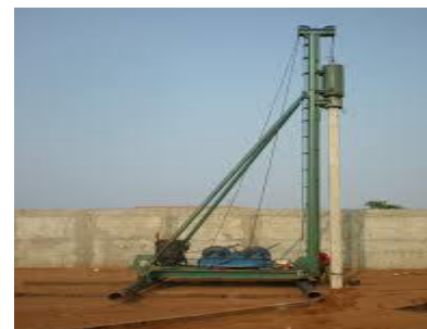
Martinete de cabrestante, Doctor Ingeniero Víctor Yepes Piqueras https://victoryepes.blogs.upv.es/tag/tablestacas/
