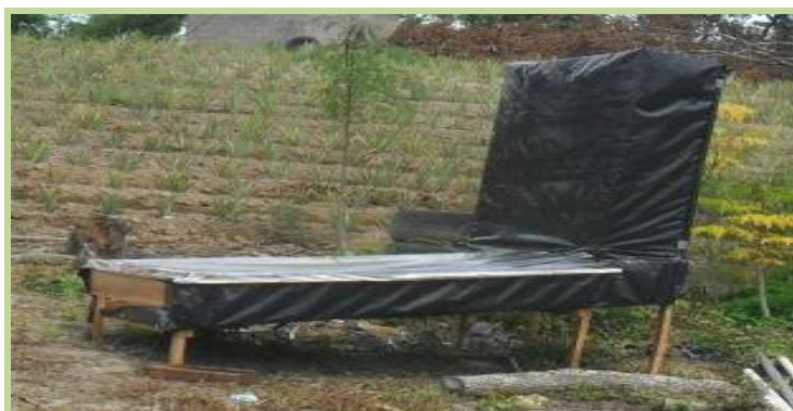
Figura 2.11 Secador solar utilizado para el secado de las hojas de Stevia rebaudiana bertonii. Cojutepeque, El Salvador. Ref.: Torres J.G (2012)
