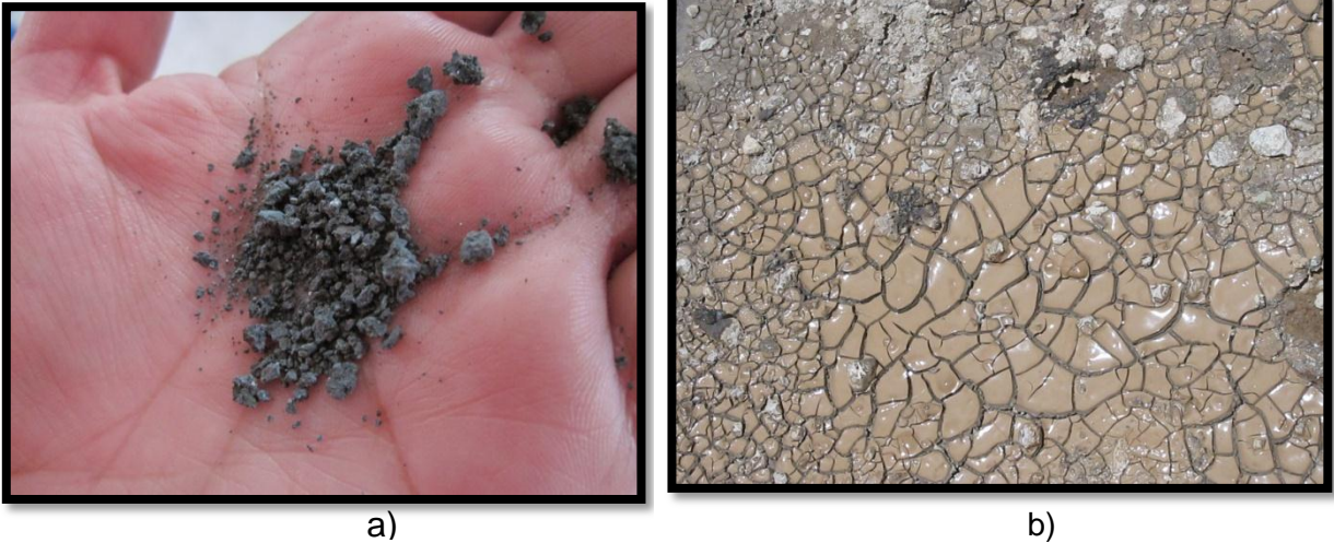
Figura 3.2 a) Recortes de Perforación y b) Lodos de perforación en reposo
