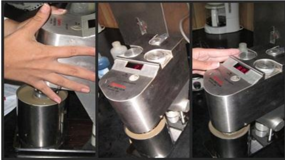
Figura 8 Proceso para determinar la viscosidad utilizando el reómetro de Fann (pruebas realizadas en el laboratorio de la Perforadora Santa Barbara, Berlín Usulután)
