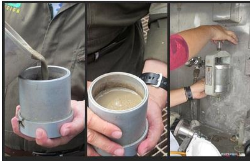
Figura 9 Se vierte la muestra de lodo en la celda para realizar el filtrado (pruebas realizadas en el laboratorio de la Perforadora Santa Barbara, Berlín Usulután)
