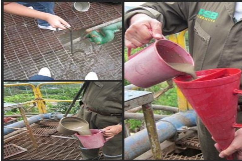
Figura 7 La muestra de lodo es de la presa de succión y esta es vertida en el embudo de Marsh (pruebas realizadas en el laboratorio de la Perforadora Santa Barbara, Berlín Usulután)
