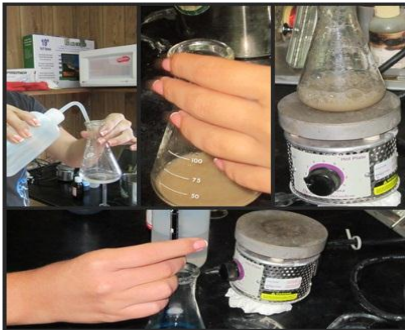
Figura 6 Pasos de 1-9 del ensayo de azul de metileno (pruebas realizadas en el laboratorio de la Perforadora Santa Barbara, Berlín Usulután)
