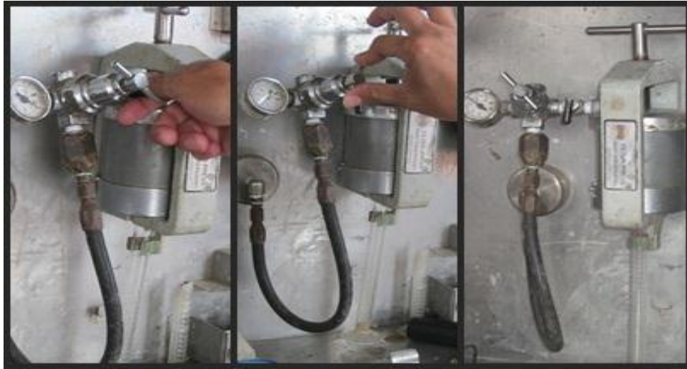
Figura 10 Se abre las válvulas de alivio y se regula la presión hasta 100 psi (pruebas realizadas en el laboratorio de la Perforadora Santa Barbara, Berlín Usulután)
