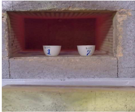
Calcinación del precipitado en mufla a 880°C
