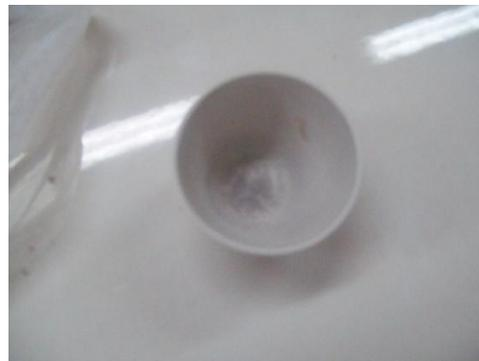
d) Cenizas del jugo después de permanecer en la Mufla por 1h a 550 °C
