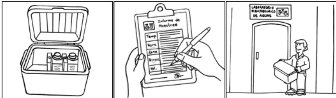
Almacene la muestra en una hielera con frigoríficos para la conservación de la muestra por el método de enfriamiento.
