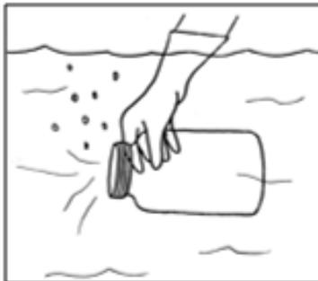
Girar el envase hasta colocarlo en sentido contrario a la corriente y en dirección paralela a la superficie, hasta que se llene desplazando todo el aire de su interior por el movimiento natural del agua.
