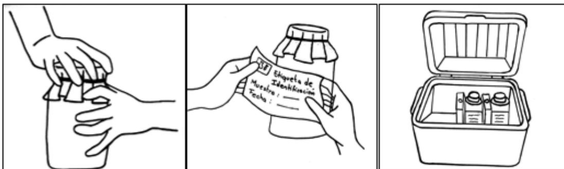
Coloque la tapa del recipiente que contiene la muestra, teniendo la precaución de no contaminar la tapa.
