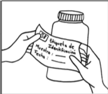
Coloque la etiqueta en el frasco que contiene la muestra de agua.
