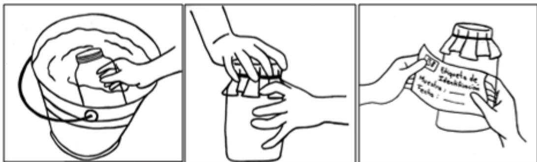
Utilice un frasco estéril con capacidad de 250 mL, destape el frasco sin soltar la tapa de la mano, para no contaminarla; tomar el frasco por su base y sumergir en el agua.
