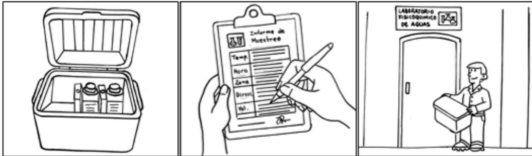
Almacene la muestra en una hielera con frigoríficos para la conservación de la muestra por el método de enfriamiento.
