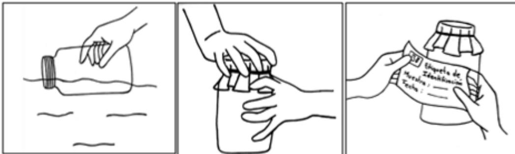
Introducir en la masa de agua superficial el frasco estéril, tomándolo por su base y sumergiéndolo en el agua horizontalmente en dirección de la boca del frasco.
