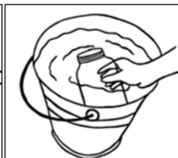
Llene el frasco completamente evitando dejar aire atrapado en su interior colocando la tapa dentro del agua.
