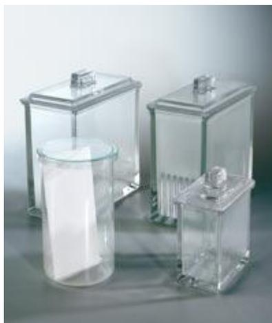
Figura N° 22 Cámara de separación de cromatografía en capa fina.
