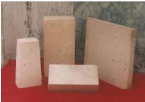
Fig. 1.9. Diferentes formas de materiales refractarios prefabricados.
