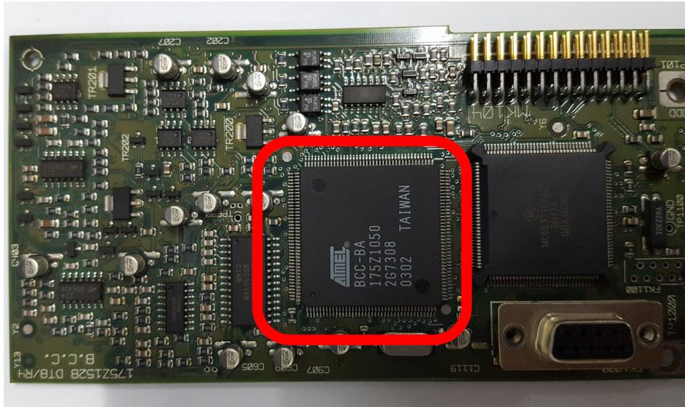
Figura 3: Microcontrolador Atmel en placa de control de VFD Danfoss VLT 6000 HVAC.
