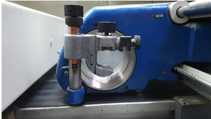
Figura 23: Vista lateral del cabezal donde se fijan los cilindros de estampación.
