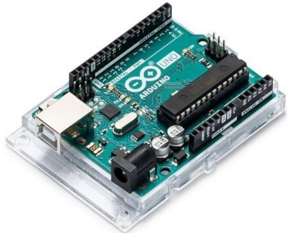
Figura 8: Placa electrónica de desarrollo Arduino UNO
