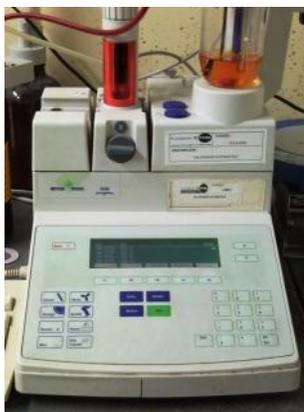
Figura N°25. pHmetro utilizado en el Experimento N°5. Marca Mettler Toledo DL53.
