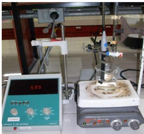
Figura N°22. pHmetro utilizado en la Valoración Acido Débil – Base Fuerte.
