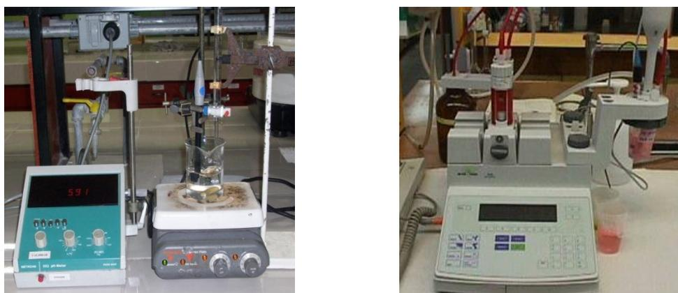
Figura N° 20. Electrodos Marca Metrohm-632 y Mettler Toledo DL53(10) utilizados en la realización de las titulaciones detalladas en el Cuadro N°1.
