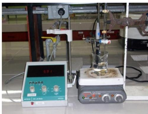
Figura N°21. pHmetro utilizado en Valoraciones Acido Fuerte- Base Fuerte marca Metrohm-632.
