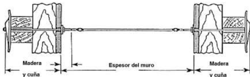
Figura 2-19. Ties de encofrado para muros de concreto. Peurifoy, (2011)
