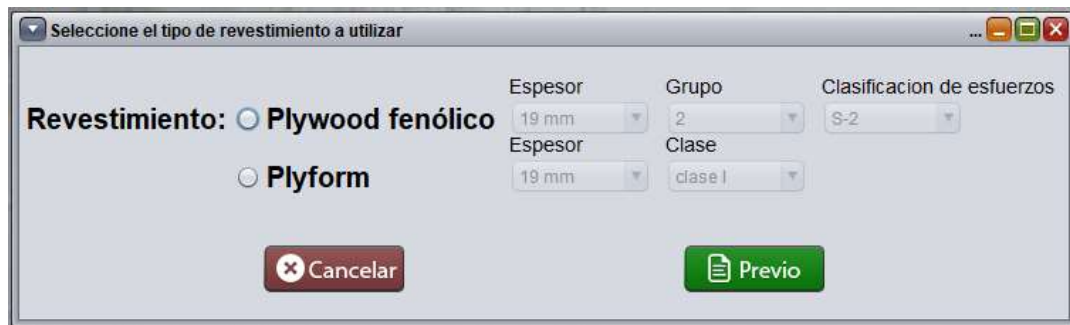
Figura 4-38. Selección del revestimiento que compondrá al sistema de encofrados mediante el sistema de vigas H20. Universidad de El Salvador, (2021).
