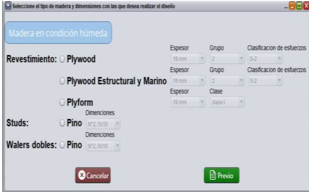
Figura 4-37. Selección de los miembros que compondrán a los sistemas de encofrados de muros mediante madera. Universidad de El Salvador, (2021).
