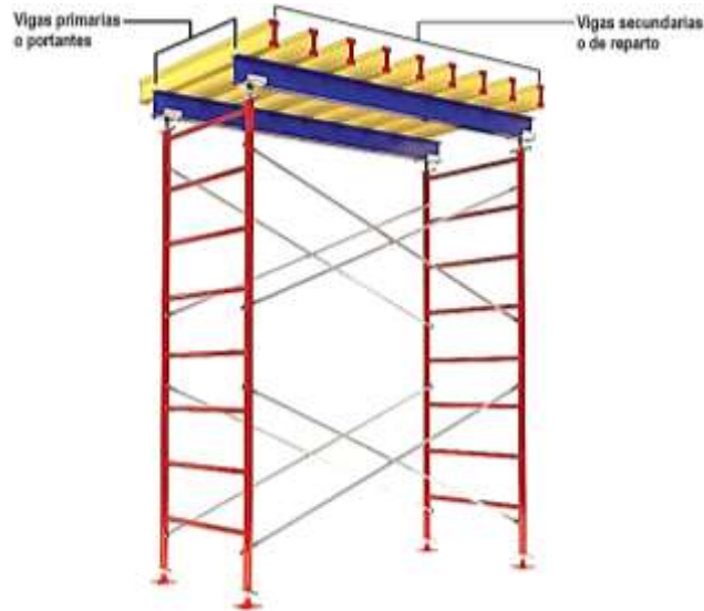
Figura 3-1. Claros simples a lo largo de vigas secundarias en asientos para encofrados de vigas de concreto. ARRECONSA, (2018).
