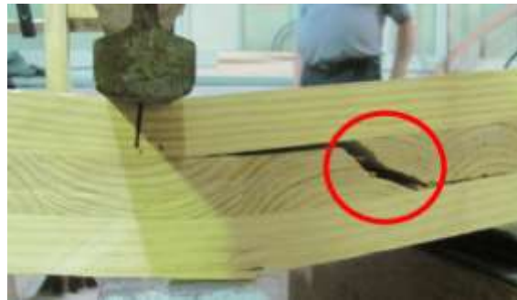
Figura 3-2. Falla por rodamiento de capas en plywood (Rolling Shear) (Saavedra, 2015)
