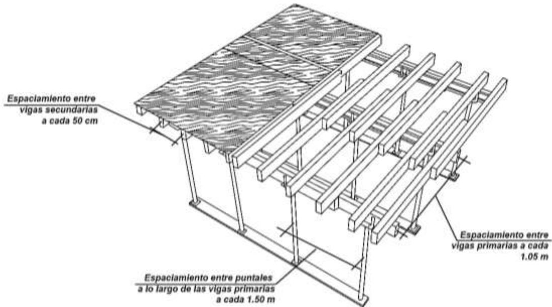
Figura 3-11. Distribución entre vigas primarias, secundarias y puntales para el encofrado de losas dado. (Martínez, 2019)
