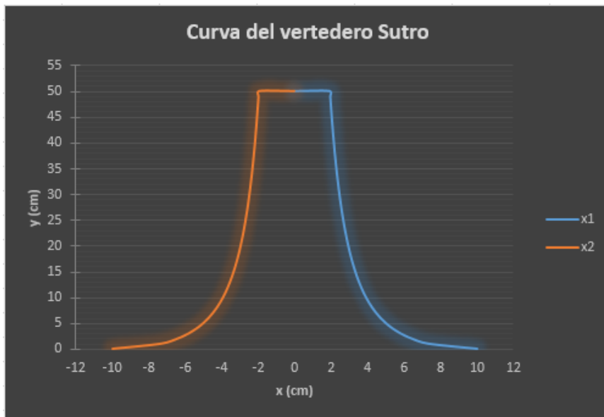
Ilustración 6-14, gráfico de la curva de vertedero de Sutro.
