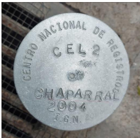
Figura 4.3 Placa de identificación de vértice geodésico.
