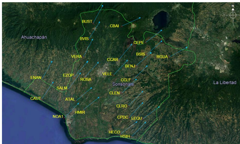
Figura 6.2 Modelación de desplazamientos de los vértices de la red de Sonsonate.
