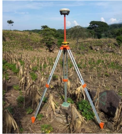
Figura 5.12 Receptor GPS acoplado y nivelado.
