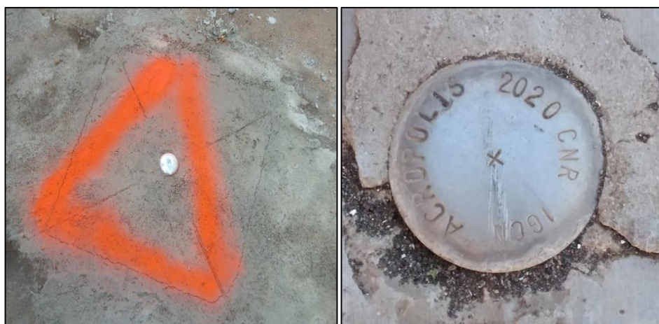
Figura 5.9 Vértices geodésicos en estructuras existentes y placas geodésicas.
