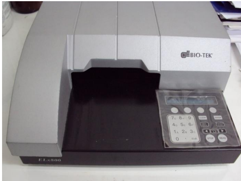
Fig N°. 14 Lector de Placas Elisa para cuantificación de micotoxinas
