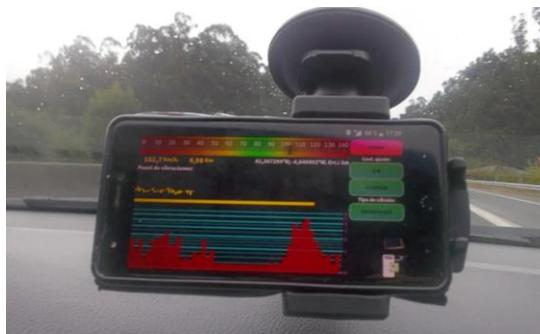
*Figura 56. Imagen de la aplicación telefónica para calcular el IRI.*
