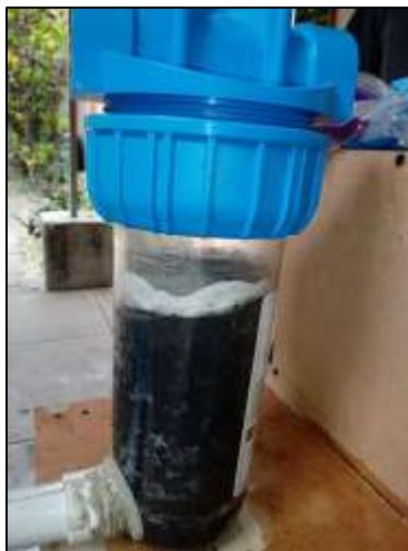
**Figura 4.18 Segunda etapa del sistema de potabilización en el experimento óptimo (Remoción de Hierro y Manganeso).**
