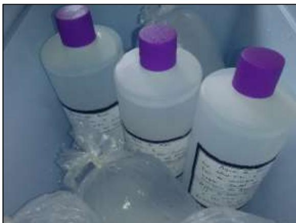
**Figura 4.1 Fotografía de los envases de HDPE utilizados para la toma de muestras de agua para los análisis fisicoquímicos.**
