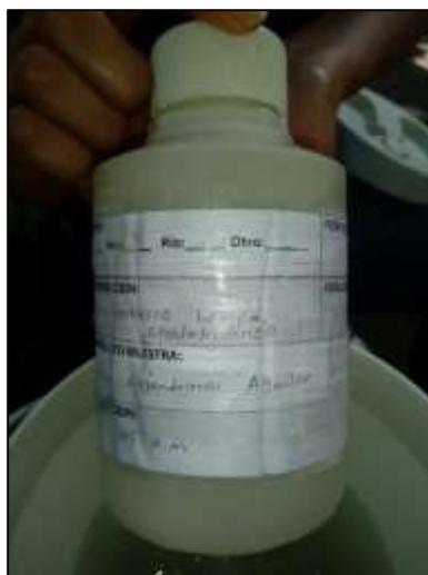
**Figura 4.2 Fotografía del frasco de polipropileno utilizado para la toma de la muestra para los análisis microbiológicos.**
