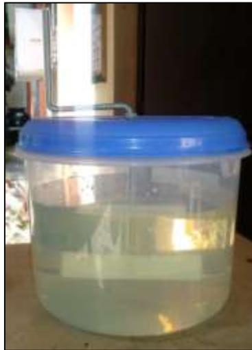
**Figura 4.17 Primera etapa del sistema de potabilización en el experimento óptimo (Oxidación de Hierro y Manganeso con Hipoclorito de Calcio al 70 %).**
