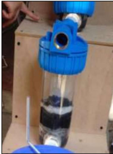
**Figura 4.5 Tercera etapa del sistema de potabilización en prueba preliminar.**
