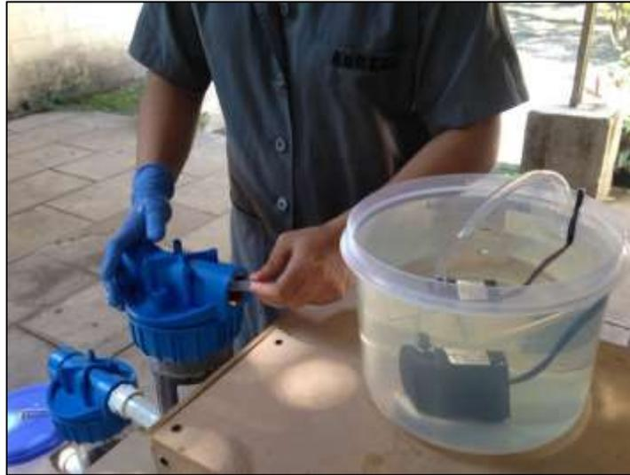
**Figura 4.6 Montaje del sistema de remoción preliminar.**
