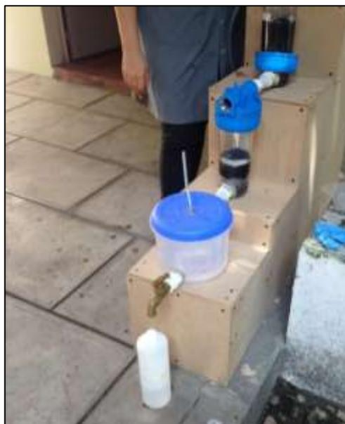
**Figura 4.7 Toma de la muestra a la salida del tratamiento preliminar.**
