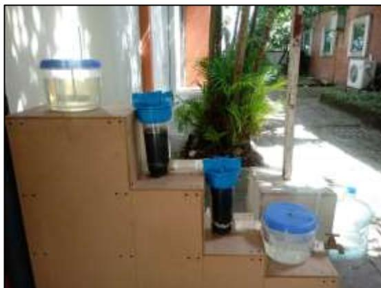
**Figura 4.21 Sistema de potabilización de agua de pozo del cantón Los Menjívar a nivel de laboratorio en condiciones óptimas.**
