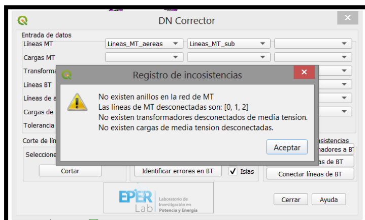
Ilustración 16 Plugin DNCorrector demostrando errores en el circuito realizado.
