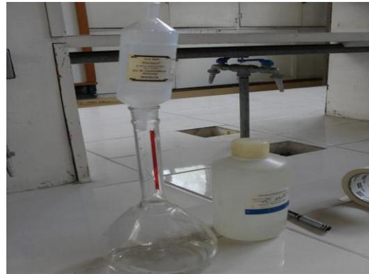
**Fig. N° 43.** Preparación de Titrsoles.
