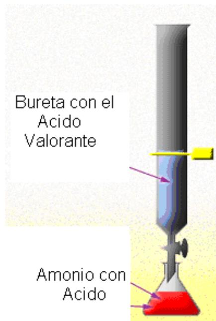
Figura N° 40. Aparato utilizado para llevar a cabo el Método de Kjeldahl. En la Figura Superior se encuentra el aparato para la Digestión y Destilación. En la Figura Inferior se observa el aparato de Valoración.
