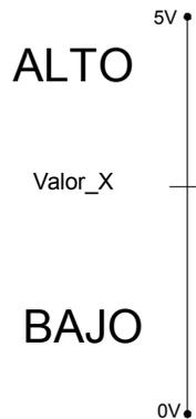
Figura 1.34 Rangos de la señal para el puerto de entrada analógica
