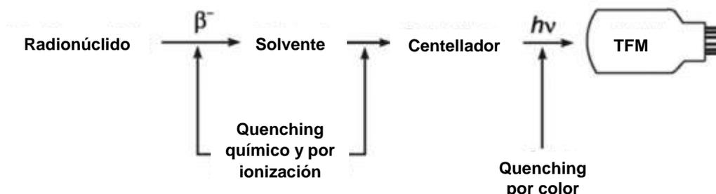
**Figura 2.12** Quenching durante la transferencia de energía en el proceso de centelleo líquido. Fuente: (L'Annunziata, 2012).
