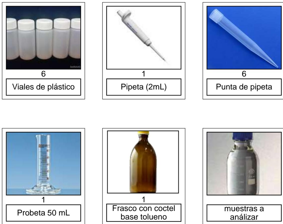
**Figura 3.9** Materiales necesarios para el análisis de radón ( $^{222}\text{Rn}$ ) en agua de consumo humano.
