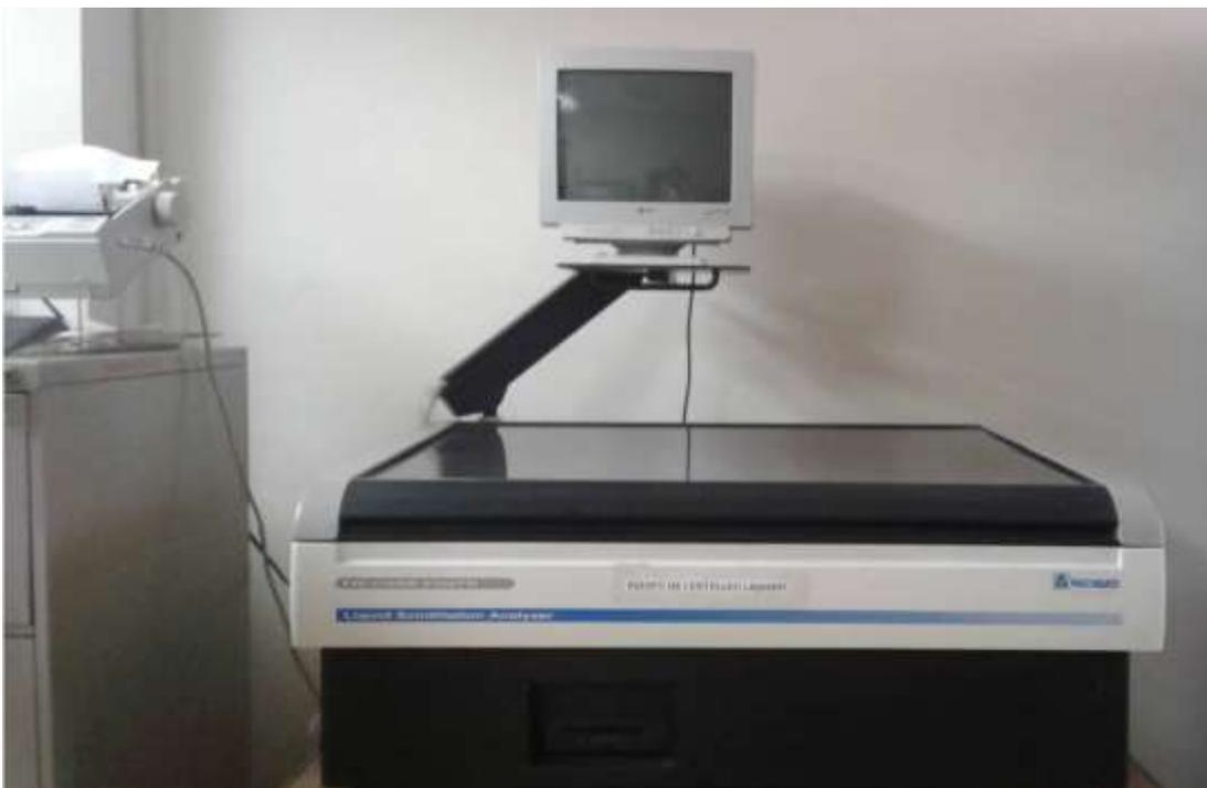
**Figura 3.6** Equipo de centelleo líquido TRICARB-2100 PACKARD, del CIAN-FIA-UES.
