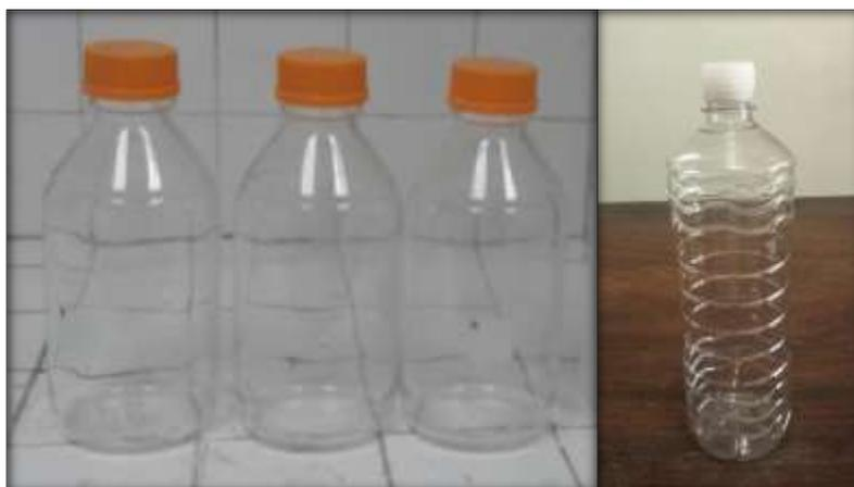
**Figura 3.2** Envases utilizados durante la recolección de la muestra, envase de vidrio (izquierda) y envase de plástico (derecha).
