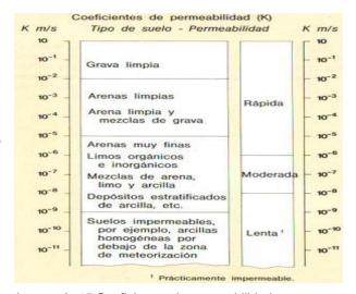
Imagen 2. 15 Coeficientes de permeabilidad.
