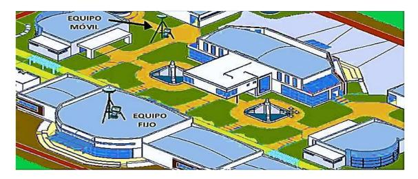
Imagen 2. 14 Ubicación recomendada para receptor Base y Móvil en técnica RTK.
