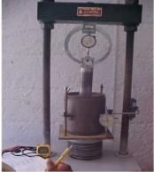
Imagen 3. 4 Aplicación presión en ensayo CBR.
