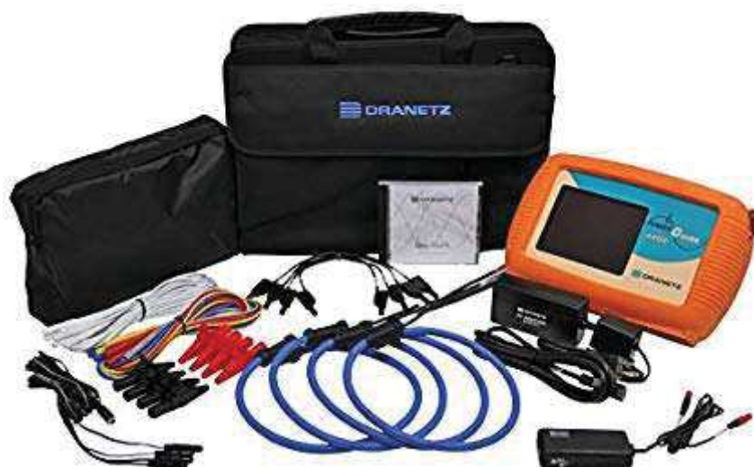
Ilustración 107: Medidor Dranetz utilizado para elaborar el perfil de carga de los edificios los cuales no contaban con el medidor instalado.
