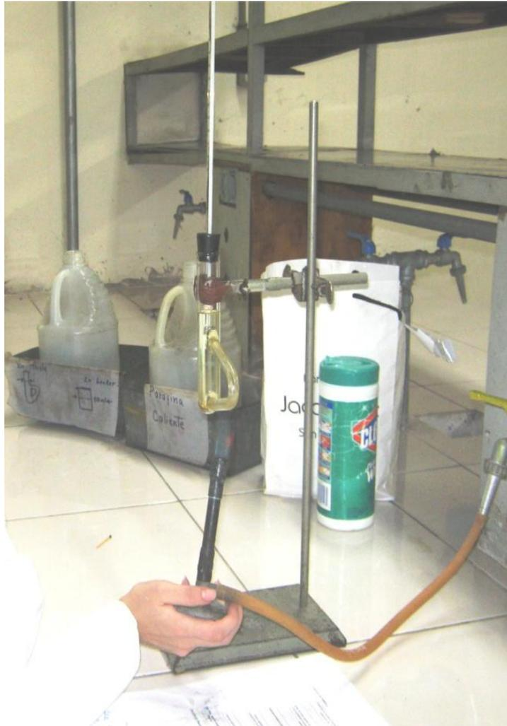
**Fig. Nº 49 Aparato para determinar el Punto de Fusión**
