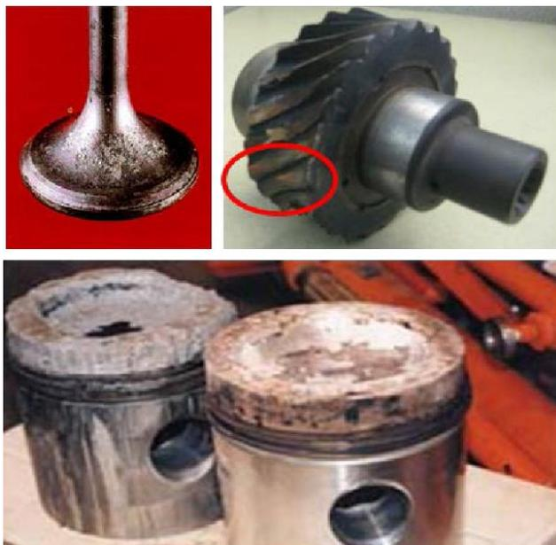
*Figura 2.5* Efectos del sulfuro de hidrógeno sobre elementos no ferrosos. Asientos de válvulas, engrane de bronce y cabezas de pistón (Salazar, 2012).
