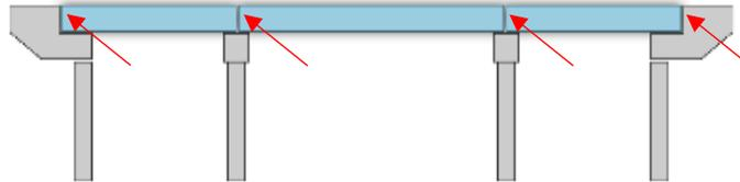
Imagen 18: Ejemplo de puente de vigas en tramos isostáticos.
