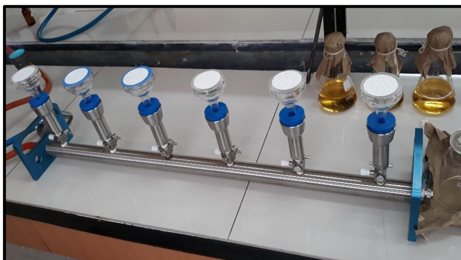
Figura N° 5. Membranas estériles de 0.45 mm utilizadas en el proceso de filtración.
