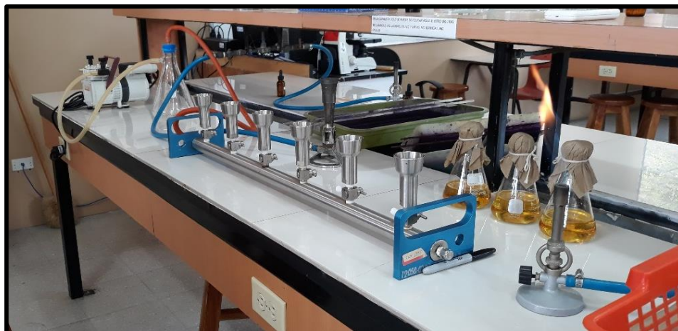
Figura N° 4. Aparato de filtración por membrana utilizado en el procesamiento de las muestras.
