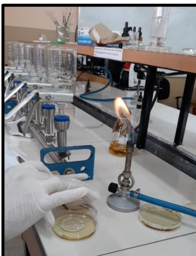
Figura N° 7. Caldo Brucella conteniendo la membrana utilizada en el proceso de filtración
