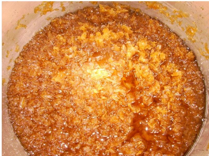
Figura N° 24 Quitina después del proceso de reflujo con NaOH al 50%
