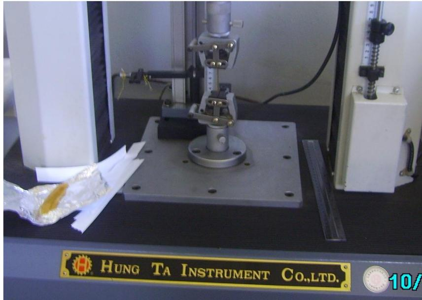
Figura N° 35 Equipo tipo HT-9102, marca HUNG-TA utilizado en el ensayo de elongación
