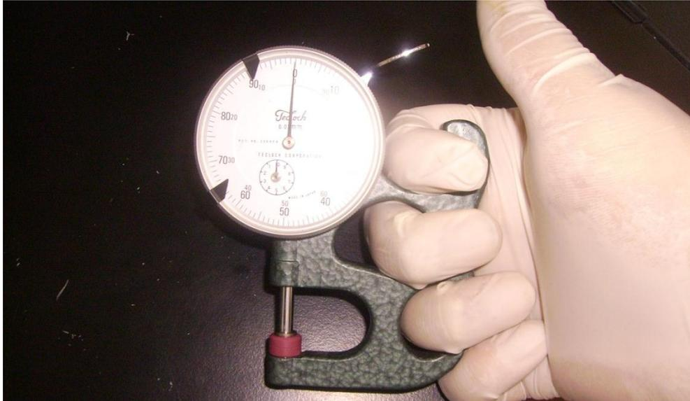
Figura N° 31 Micrómetro analógico Teclock modelo SM-112
