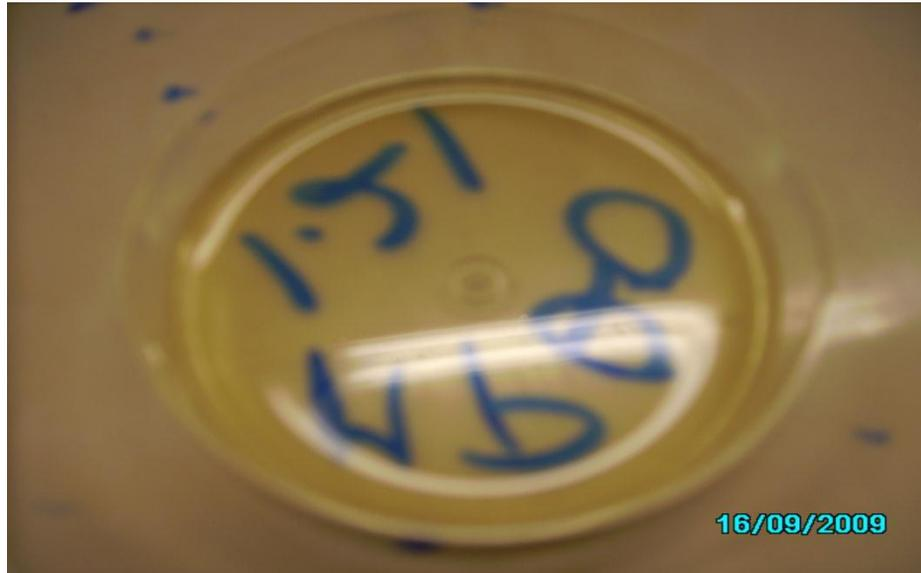
Figura N° 27 Película de quitosano + aceite de oliva 1.2% base poliestireno durante el proceso de moldeo
