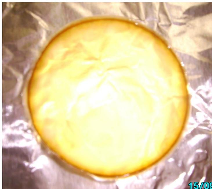
Figura N° 30 Película de quitosano después del desmolde de la base poliestireno
