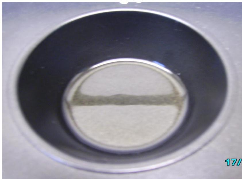
Figura N° 28 Película de quitosano + glicerina 1.2% base teflón durante el proceso de moldeo
