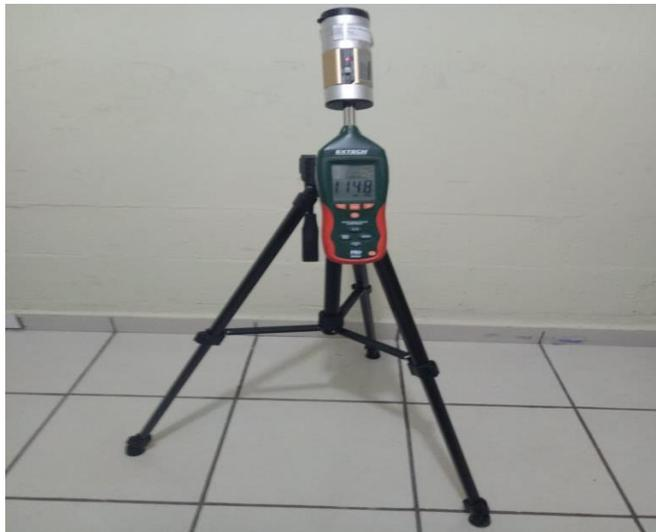
Figura N°21. Sonómetro más Calibrador Acústico.
