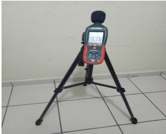
Figura N°20. Sonómetro más trípode listo para medir contaminación acústica.
