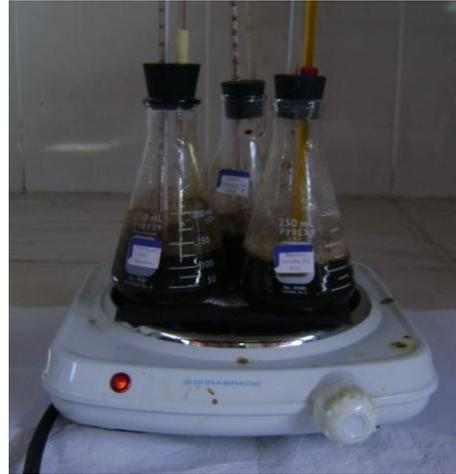
Figura N° 34. Adicionar 5.0 mL de  $\text{KMnO}_4$  a una concentración de 5% y reflujar durante 4 horas.
