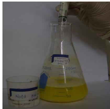
Figura N° 33. Tomar pH inicial con papel indicador y regular el pH con HCl 0.1 N ó NaOH 0.1 N.
