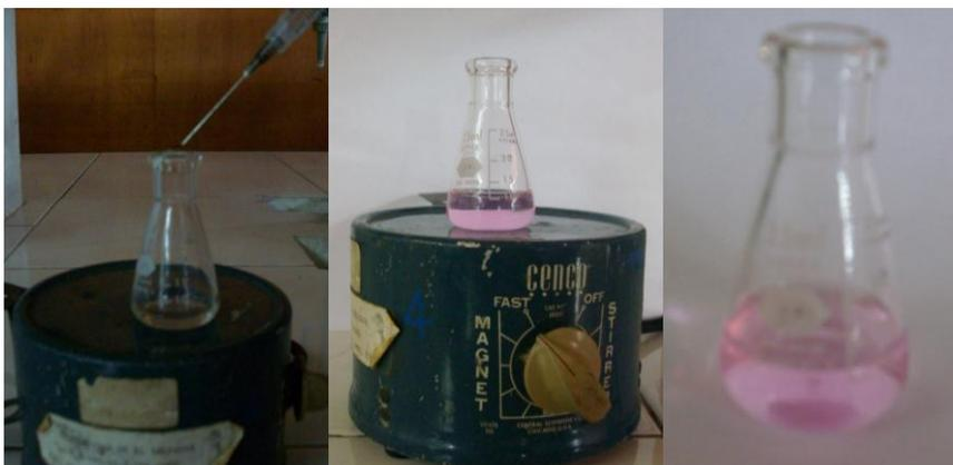
Figura N° 49 Proceso del Equivalente de Neutralización en microescala.
