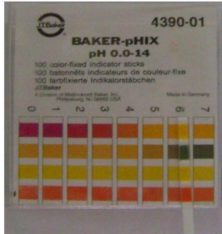
Figura N° 35. Filtrar la muestra y tomar el pH final.
