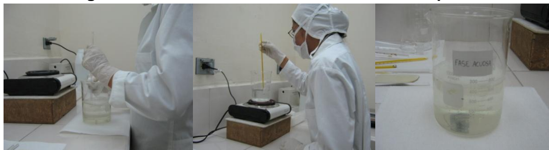
Figura No 22. Preparación de La fase acuosa.
