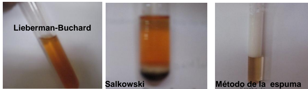
Figura No 10. Pruebas para la identificación de Saponinas
