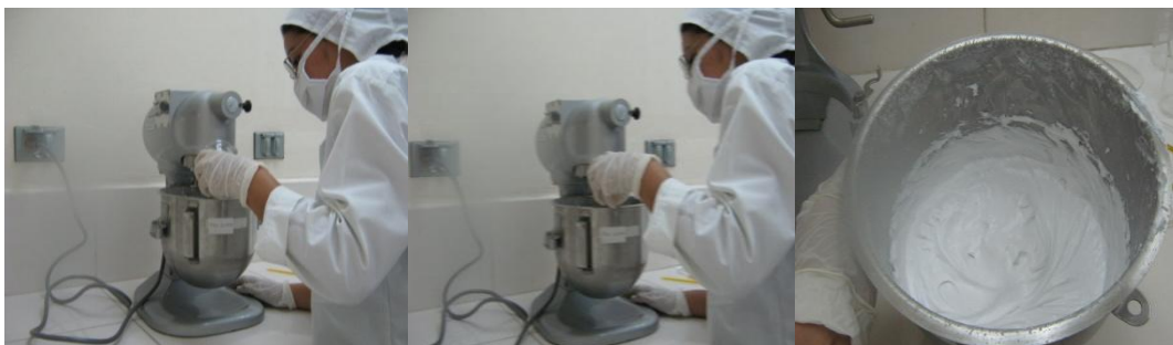
Figura No 25. Incorporación de Látex
