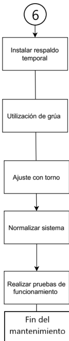
Figura 37. Proceso de mantenimiento para falla con respaldo temporal.
